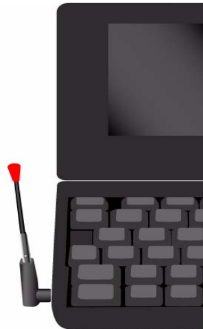
Figure 4-1 : Positionnement correct de l'antenne du AirCard modem pour AirCard 850 modem/AirCard 860 modem
